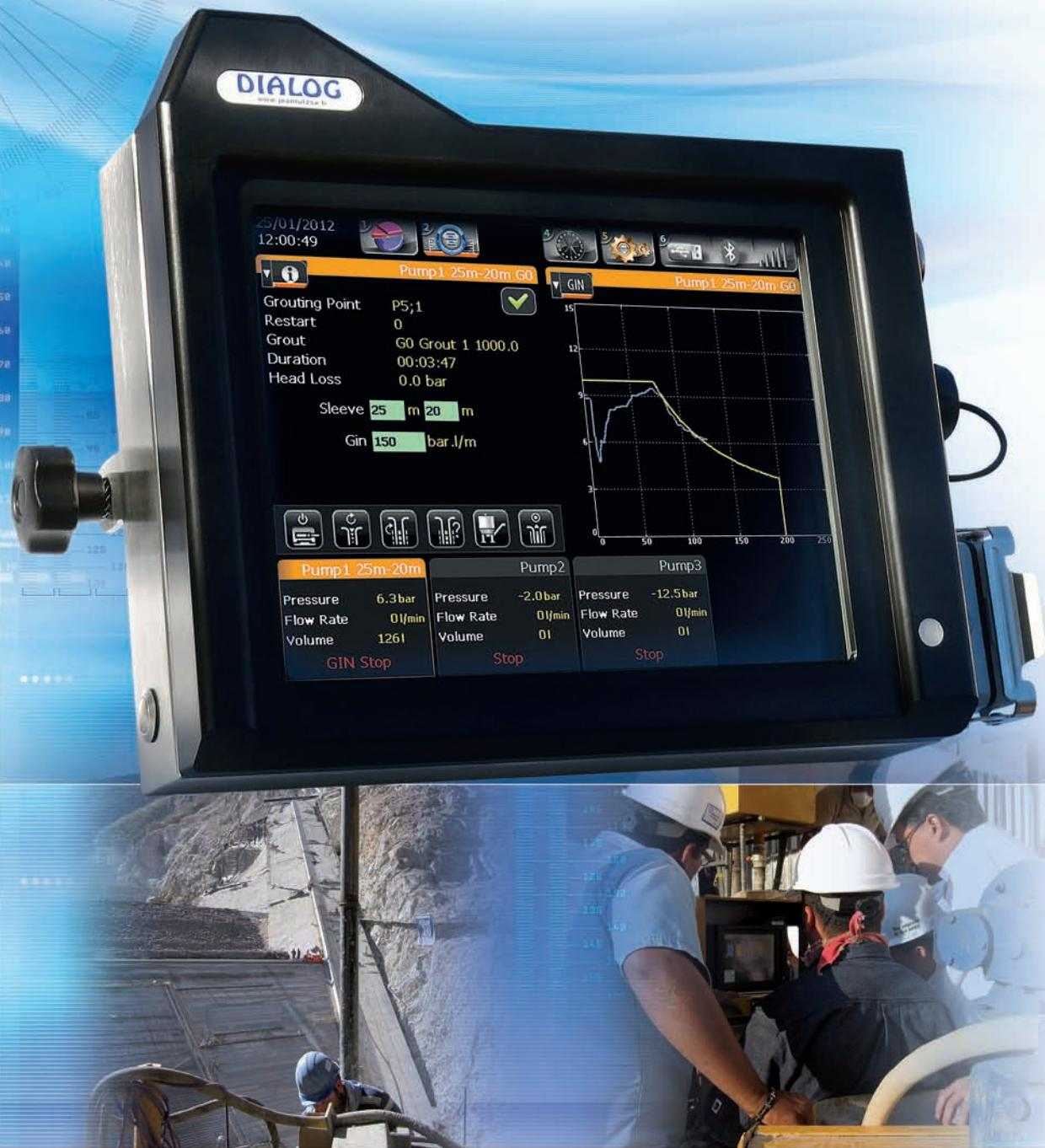
Le DIALOG en version PVD est un appareil de mesure, de pilotage et d'enregistrement des paramètres d'injection.
